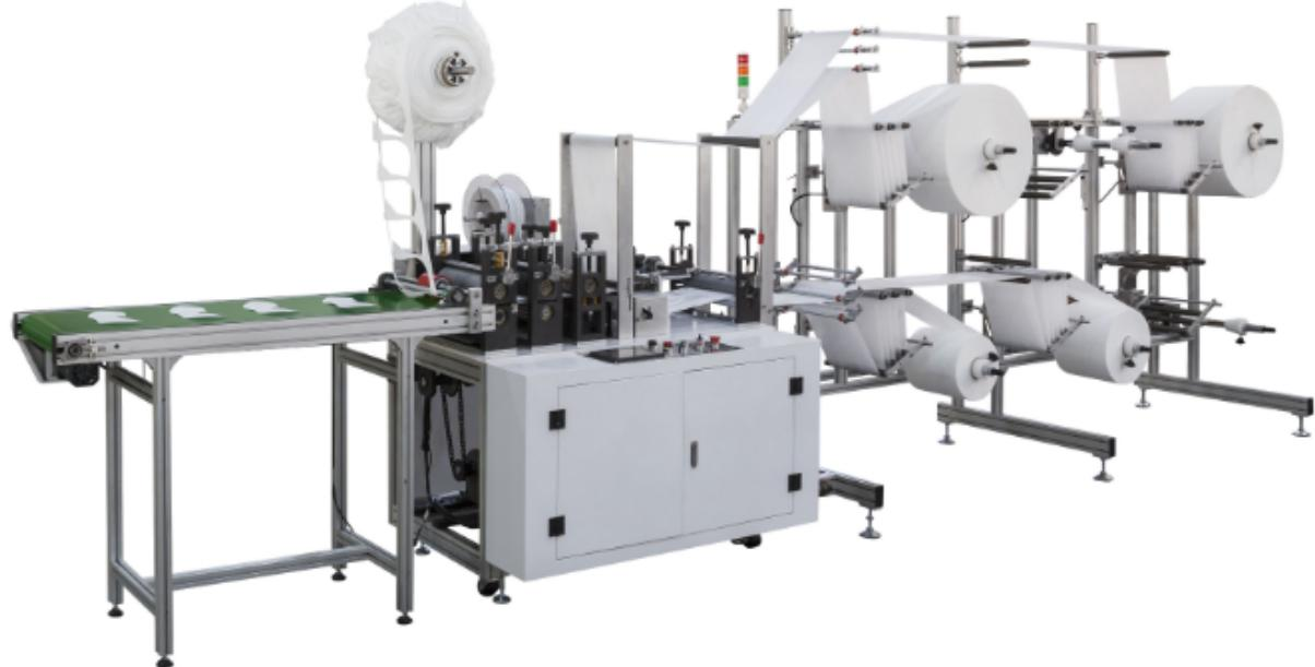
特点：利用超声波焊接，免用针线，省去频繁换针线的麻烦，没有传统线缝合的断线接头情况，还可对纺织品进行整洁的局部剪切与密封。缝合的同时也起到了装饰的作用，粘固力强，可达到防水效果，压纹清晰，表面更加具有立体浮雕效果，工作速度产品效果好更显高大上美观；品质有保证。利用超声波及特制钢轮加工，密封的边缘不开裂，不伤布类边缘，且没有毛边、卷边现象。制造时不需预热，并可连续操作。操作简便，和传统缝纫机操作的方法没有多大区别，普通缝纫工可以操作。成本低，比传统机器快到5到6倍，效率高。
