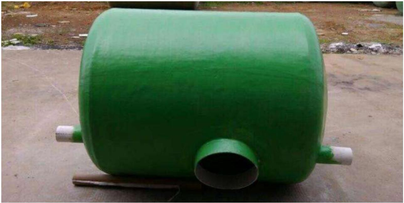
玻璃钢学名纤维增强塑料，俗称FRP即Fiber Reinforced Plastics，即纤维增强复合塑料。根据采用的纤维不同分为玻璃纤维增强复合塑料GFRP、碳纤维增强复合塑料CFRP、硼纤维增强复合塑料等。它是以玻璃纤维及其制品（玻璃布、带、毡、纱等）作为增强材料，以合成树脂作基体材料的一种复合材料。纤维增强复合材料是由增强纤维和基体组成。纤维（或晶须）的直径很小，一般在 $10\mu\text{m}$ 以下，缺陷较少又较小，断裂应变约为千分之三十以内，是脆性材料，易损伤、断裂和受到腐蚀。基体相对于纤维来说，强度、模量都要低很多，但可以经受住大的应变，往往具有粘弹性和弹塑性，是韧性材料。
